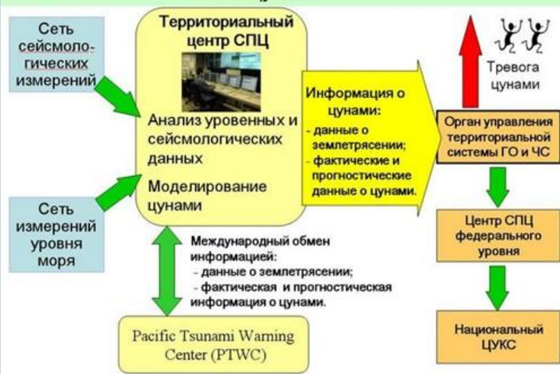
Схема информационного обмена в службе предупреждения о цунами
