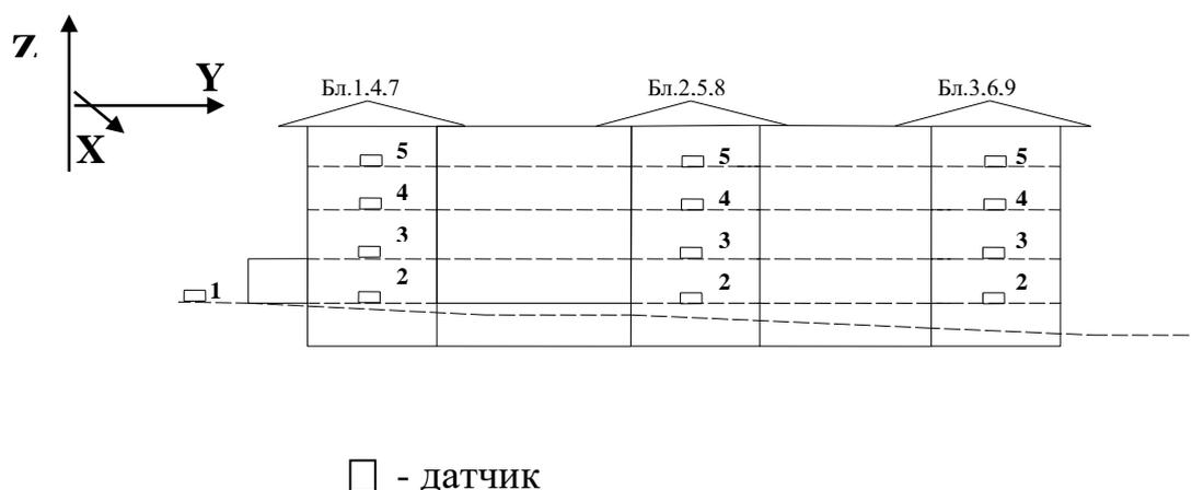
Рис. 1 - Пример схемы расстановки датчиков в корпусе В-2 (бл.1-9) здания казармы финансовой полиции в Республике Италия, в эпицентральной зоне катастрофического землетрясения в г. Ак-Вила провинции Абруццо.
